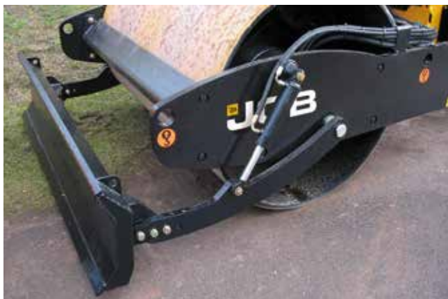
Отвал для выравнивания грунта.
